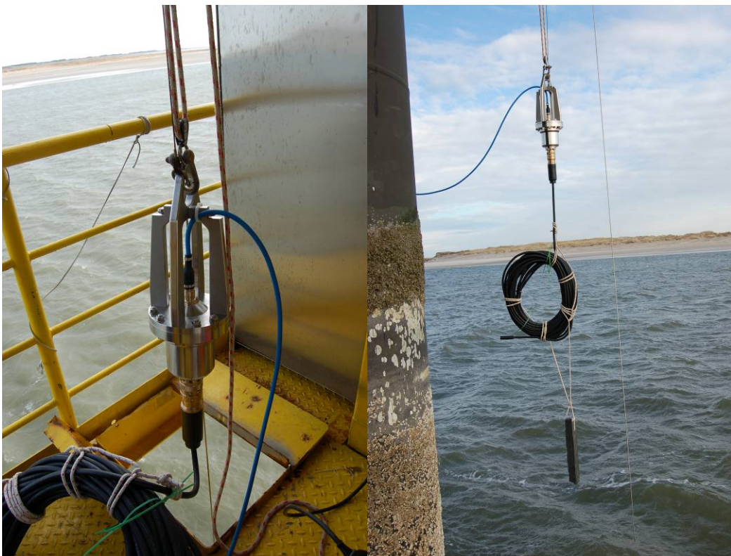
Abbildung 3: Erprobung des Steckverbinders auf der Messstation der Universität Oldenburg am 17. 2. 2009.
