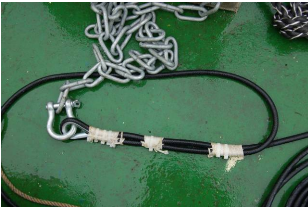
Abbildung 7: Befestigung des Datenkabels an der Kette des Ankersteins.
