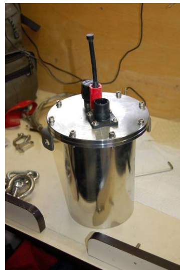
Abbildung 2: Datenlogger und Energieversorgung (wasserdichtes Gehäuse) für die Erprobung an einer Verankerung.
